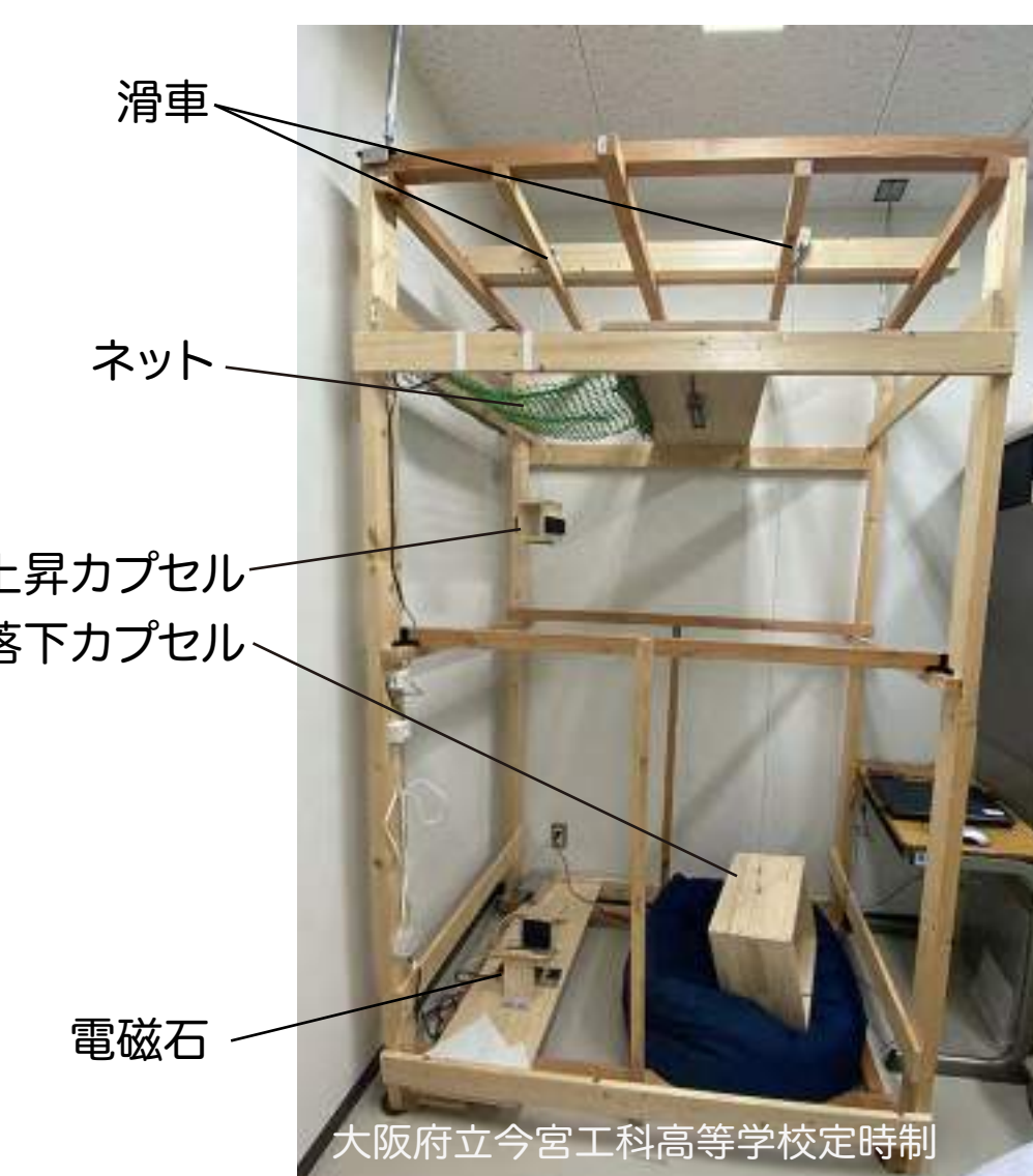
2 個の滑車を用いたシステム
