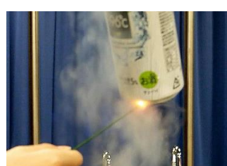
【⑤アルミ缶中の液体窒素が酸素を液化、線香実験】
